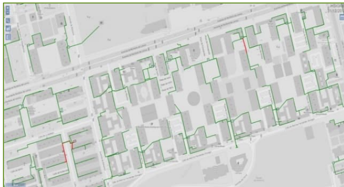
Red de distribución eléctrica en zona urbana Madrid Impacto recarga lenta nocturna en red de Baja Tensión
